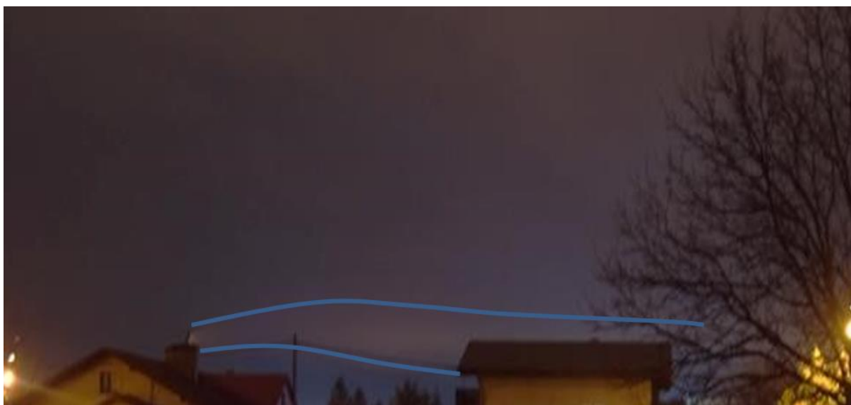
Rys. 8. Smuga kominowa zaobserwowana w dniu 27 grudnia o godzinie 18:00 – typ wentylacyjny (fot. R. Szczepaniak).
