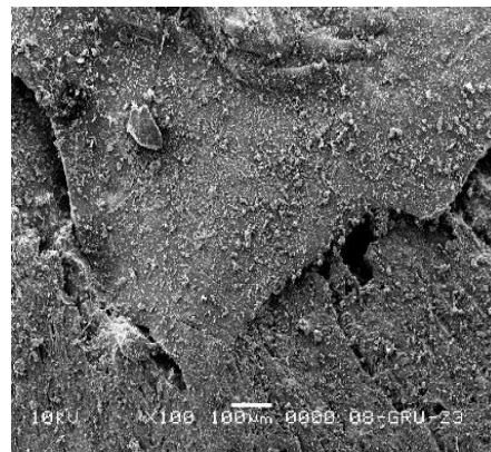
Rys. 25. Zdjęcie SEM próbki oznaczonej numerem 6 – 3M (próbka po trzecim miesiącu biodegradacji). Fig. 25. SEM photo of the sample marked with number 6 – 3M (sample after the third month of biodegradation).
