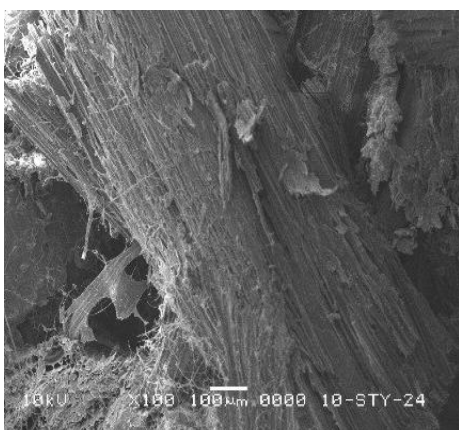
Rys. 20. Zdjęcie SEM próbki oznaczonej numerem 1 – 2M (próbka po drugim miesiącu biodegradacji). Fig. 20. SEM photo of the sample marked with number 1 – 2M (sample after the second month of biodegradation).
